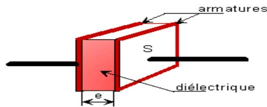
Valeur de la capacité d'un composant capacitif plan
